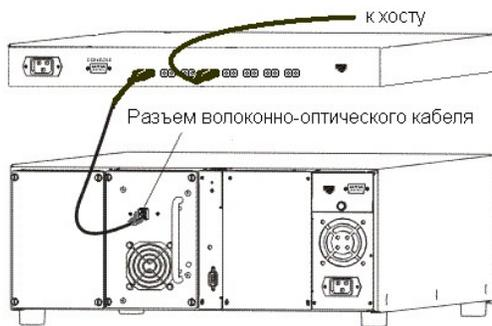
**Рисунок 4. Кабели FC, соединяющие два накопителя к коммутатору**
